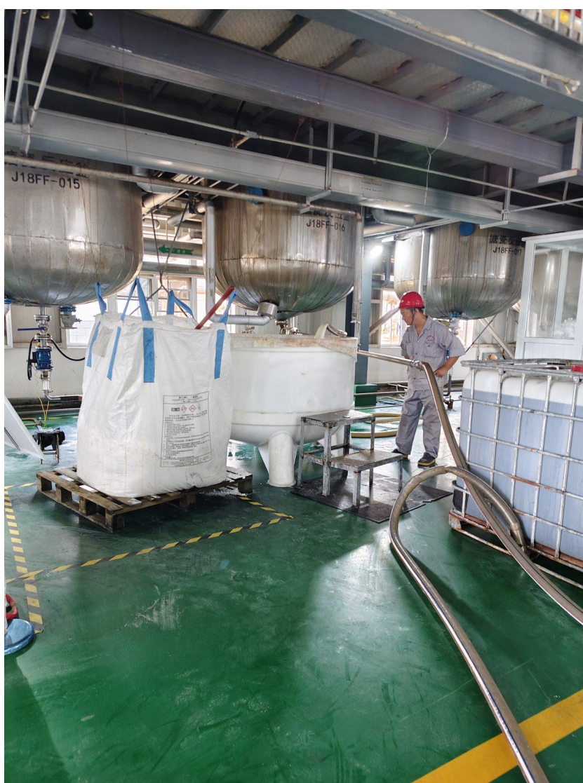
改进前：溶剂采用 IBC 吨桶（塑料吨桶）包装运送（生产车间现场）。
